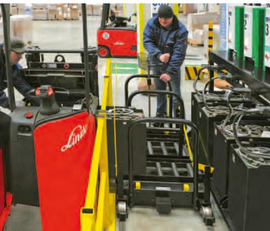
Automatisierte Batterieladestation: Rollenbrett und Verschiebewagen helfen beim Wechsel
